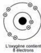
La couche extérieure de l'atome peut accepter 8 électrons pour obtenir une stabilité chimique. L'atome d'oxygène peut donc accepter 2 électrons supplémentaires. Pour cette raison, les électrons de 2 atomes d'hydrogène peuvent se fixer sur la couche externe de l'atome d'oxygène et ainsi former une molécule d'eau
